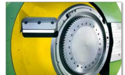
Langmesser-Spanerscheibe mit nachschneidendem Sägering für Spanersprung
