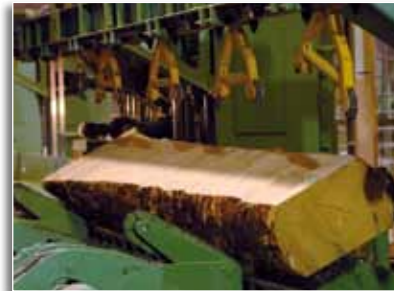
Kettenarme zum Eindrehen von Rundholz/Modeln
