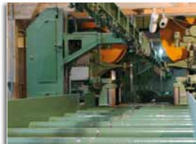
Rollengangbreite nach den Bandsägen 2000 m
