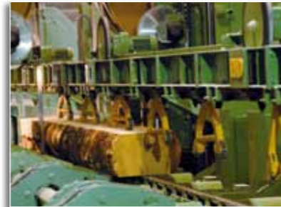
Rundholz-/Modellfixierung zwischen oberem und unterem Förderelement
