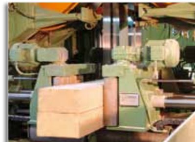
Zentrierenrichtung zur Führung des Schnittholzes nach den Bandsägeblättern
