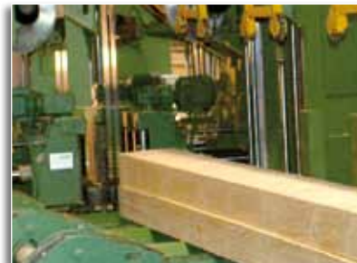
Zentrierenrichtung zur Führung des Schnittholzes vor den Bandsägeblättern
